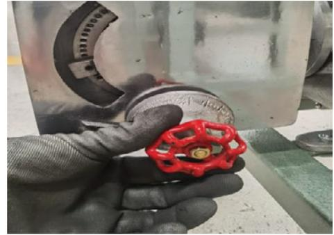
**7** Girar perilla inferior de válvula carburadora para regular intensidad de la flama.
