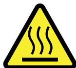
**SUPERFICIE CALIENTE** Tapas de chasis cocedor (horno) se encuentran calientes mientras se encuentra en operación y algún tiempo después hasta alcanzar temperatura ambiente.
