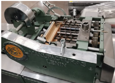
15 Verificar el correcto funcionamiento del cabezal. Cadenas y piezas móviles.
