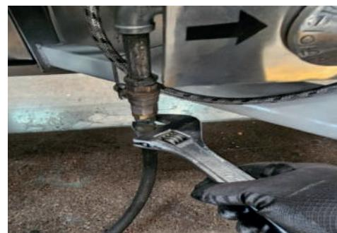
6 Conectar a toma de gas a la entrada de la válvula carburadora.
