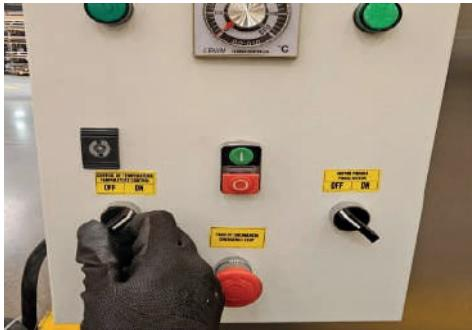
3 Accionar interruptor control de temperatura OFF/ON. Encenderá indicador OFF (luz roja)
